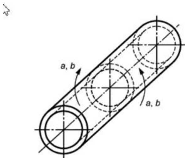
Рис. 1. Положение вертикальное снизу вверх РН (трубы неповоротная)
